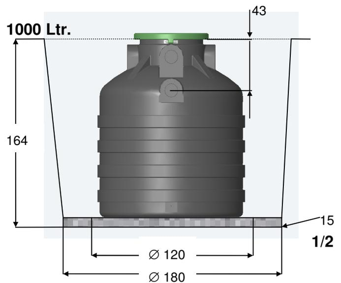
Die Abmessungen der Baugrube sind so zu wählen, daß zwischen Behälter und Grubenwand rundum ein Abstand von 30 cm vorhanden ist. Werden zwei oder mehrere Tanks nebeneinander installiert, so sollte der Zwischenraum mindestens 50 cm betragen.
