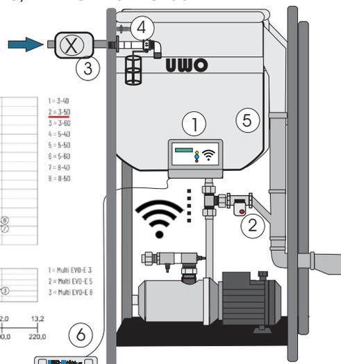
1. "uwo-smart-control" Fernüberwachung mit E-Mail Benachrichtigung bei Störung, Fernabschaltung Zulauf/Pumpe
